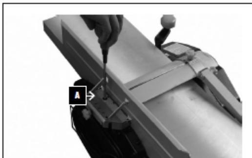
Suorista vaste oikopöydän suuntaisesti ja kiristä ruuvi. Kulma säädetään löysäämällä Torxruuvia. Tarkka säätö voidaan tehdä asteikon avulla.
