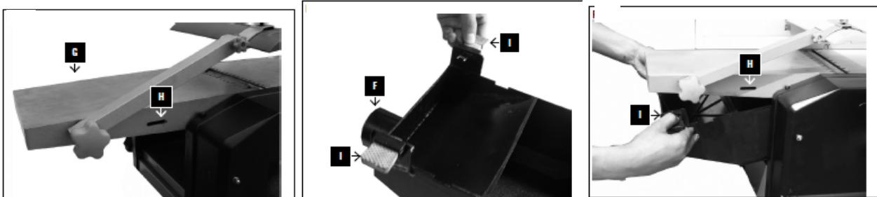
2. Planhyvling: Lossa riktanhållet. Skjut bak kutterskyddet och fäst spänstosen. Fäst spänstosen så att båda lägesbrytare är i linje med de avlånga hålen. Skjut därefter in lägesbrytarna i de avlånga hålen. För att sugsystemet ska fungera optimalt ska lufthastigheten vara minst 20 m/s.
