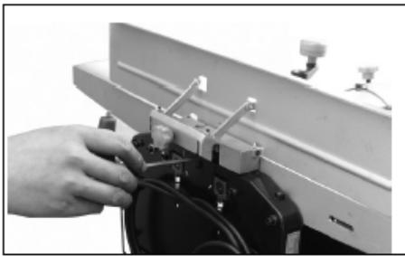
När apparaten används i ett slutet utrymme ska ett utsug anslutas till spänstosen enligt följande:
