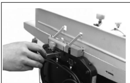
Kun konetta käytetään suljetussa tilassa, imulaite on liitettävä imuliittimeen seuraavasti:
