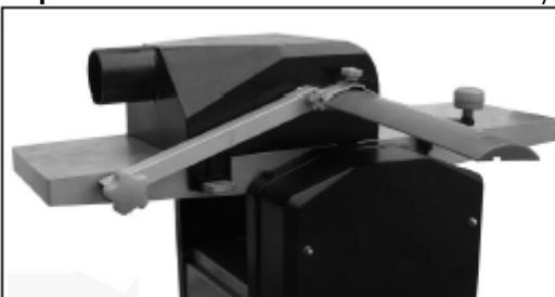
Teräkselin suojuksia: Korkeussäätö tehdään koneen vasemmalle puolelle asennetulla Torx-ruuvilla. Kun Torx-ruuvi on kierretty auki, terässuojuksen voi työntää sivuun, jolloin höyläsvyettä voi säätää. Paina teräkselin suojuksia takaisin alas, jotta saat kiinnitettyä suojuksen oikeaan asentoon, ja kiristä kiinnittimet (J ja K).
