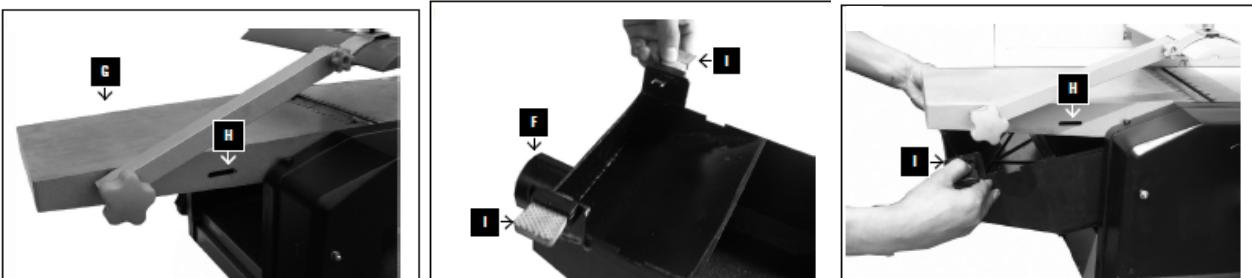
2. Tasohöyläys: Irrota oikovaste. Työnnä teräkselin suojuksella taakse ja kiinnitä imuliitin. Imuliitin kiinnitetään niin, että molemmat kytkintapit ovat pitkittäisreikien suuntaisina. Työnnä sitten kytkintapit pitkittäisreikiin. Jotta imujärjestelmä toimisi optimaalisesti, ilmannonpeuden tulee olla vähintään 20 m/s.
