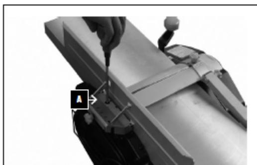
Sätt anhållet parallellt med riktbordet och dra åt skruven. Ställ in vinkeln genom att lossa på torxsksruven. Exakt inställning görs med hjälp av en skala.
