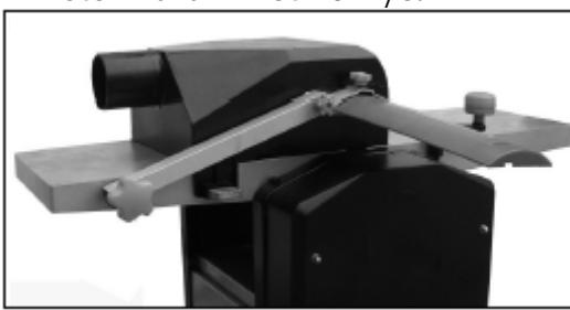
Kutterskydd: Höjden ställs in med torxskruven på apparatens vänstra sida. När torxskruven har lossats kan kutterskyddet skjutas åt sidan så att hyvlingsbredden kan ställas in. Tryck ner skyddet igen för att fixera det i rätt läge och dra åt handtagen (J och K).
