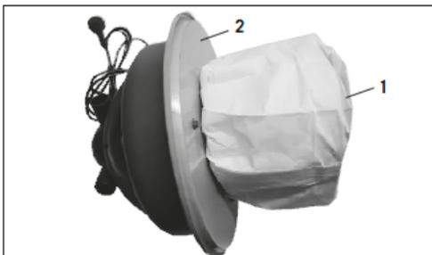
3. Sätt filterpatronen (1) på motorhuset (2). Sätt det kompletta motorhuset på behållaren och säkra med förslutningsbandet.
