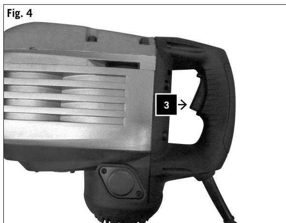
**Attention ! Pour votre sécurité, la machine doit être maintenue uniquement avec les deux poignées (3 et 4, Fig. 1) !**
