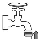
(DE) (AT) (CH) Gartenschlauch mit dem Schlauchanschluss und dem Wassereinlass des Hochdruckreinigers verbinden. Die Wasserzufuhr vollständig aufdrehen.
