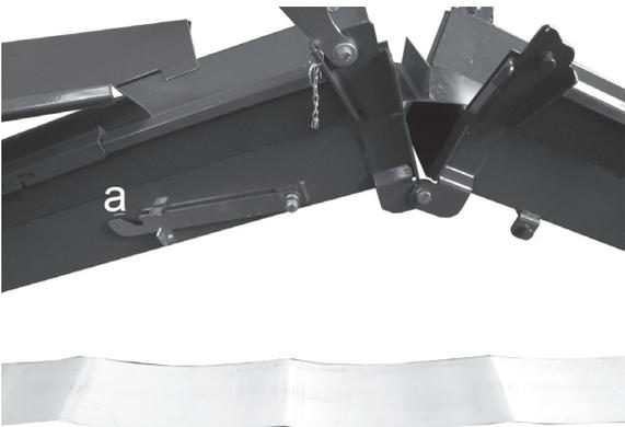
11. Förderband mit der Handseilwinde absenken bis dieses etwa 50 cm über dem Boden steht.
