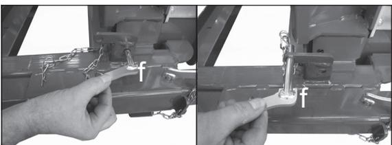
7. Stecker (f) zur Sicherung des Förderbandes entnehmen und in die Ruheposition in die linke Bohrung stecken. **Achtung!** Kollisionsgefahr Stecker erst wieder in Transportstellung einstecken wenn das Förderband hochgestellt ist.
