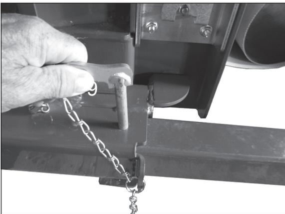
8. Stecker (9) an den Stützrohren beidseitig entfernen
