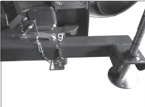
9. Stützrohr beidseitig einfahren und mit Stecker (9) sichern.
